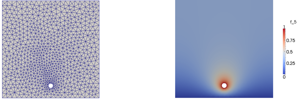
(a) Mallado de una sección transversal de un cable sobre un plano de tierra (b) Potencial eléctrico de un cable sobre un plano de tierra
