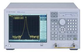
Figura 3.9: Analizador de redes Agilent Technologies E5063A
